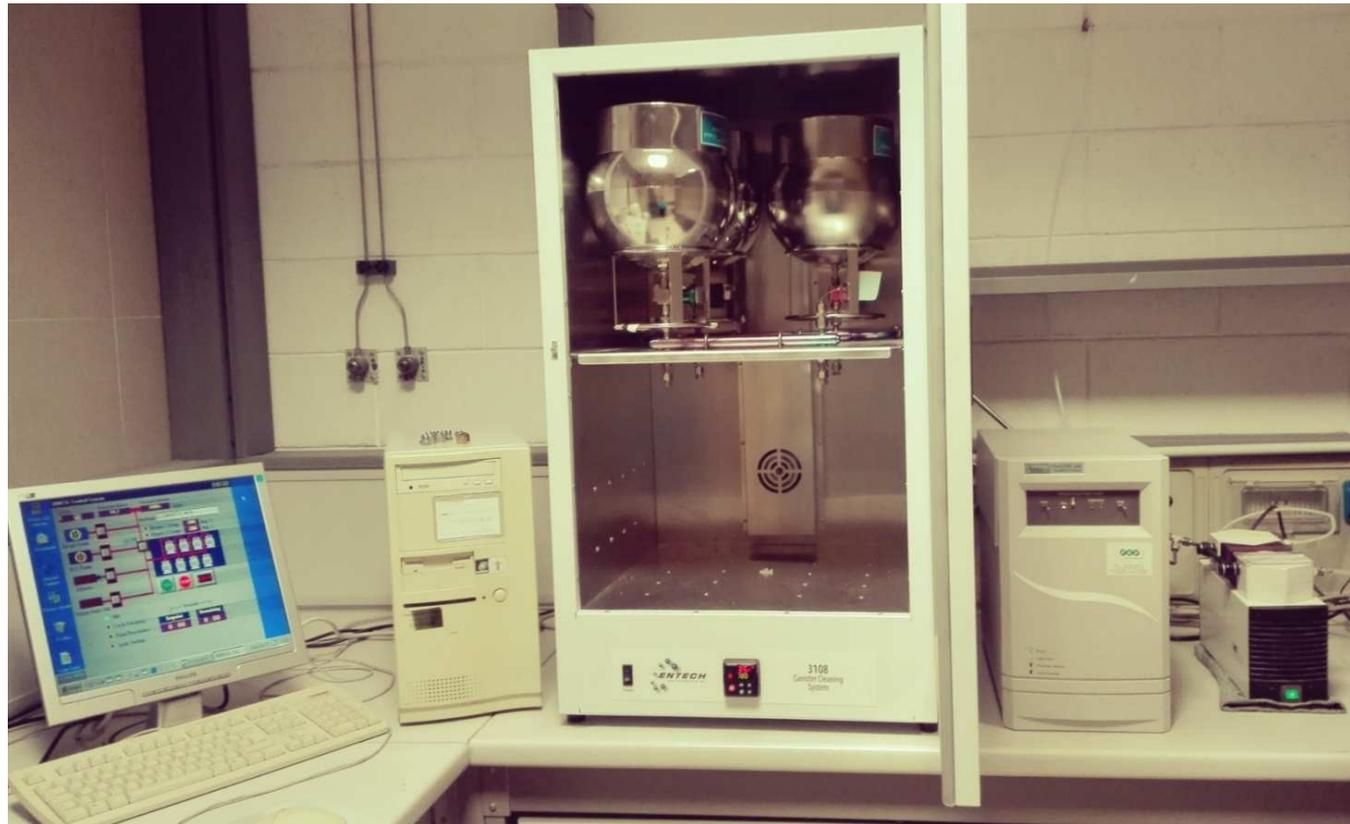
La pulizia consiste in una serie di cicli di riempimento con azoto e successivo svuotamento.
